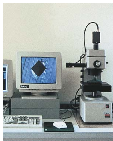
Abbildung 9: Härteprüfautomat (Archivierung der Härtewerte inklusive der Härteverlaufskurven)
