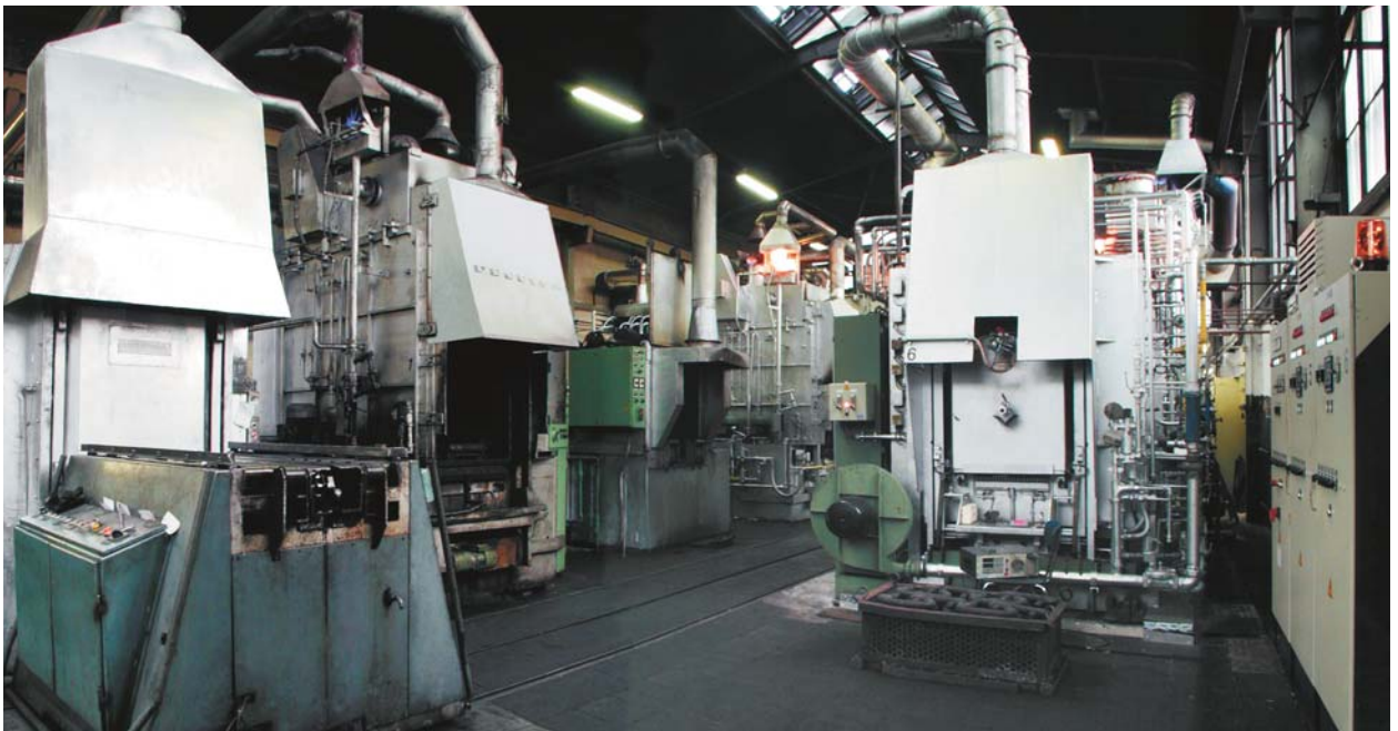
Abbildung 2: Teilansicht HEKO Härtereianlage
