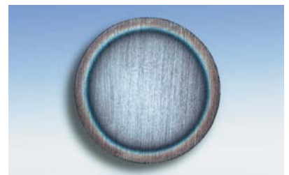
Abbildung 4: Querschnitt durch ein HEKO-Kettenglied.
